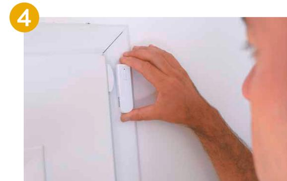
Positionnez l'élément (1) face à l'aimant et pressez fermement pendant 30 secondes.
