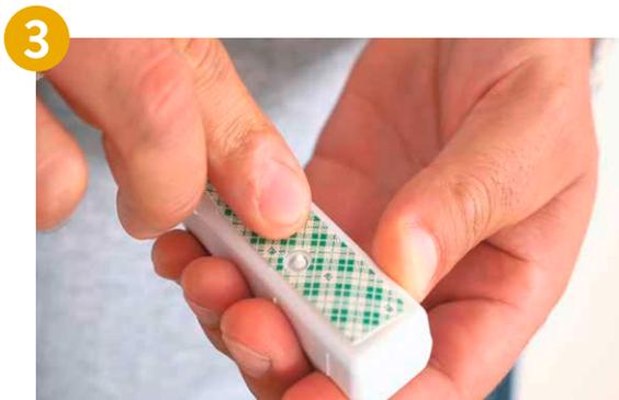
Collez l'adhésif double-face sur l'arrière de l'émetteur (1) et maintenez une pression pendant 30 secondes. Puis ôtez la languette de protection.
